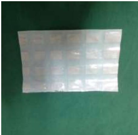
รูปที่ 3 แสดงการผนึกของอบแก๊สให้ได้ช่องกว้างประมาณ 1 ซม.
